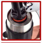
然後將柱塞桿插入柱塞,柱塞桿下端接頭部分應該完全壓入柱塞 的孔洞中。
