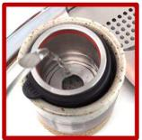
如同正常預熱汽缸一般,請將汽缸倒置於預熱容器內,預熱至少 30秒,此時因為汽缸是倒置的,所以柱塞應該是在底部。
