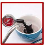
將已結合的柱塞及柱塞桿置於預熱容器內,預熱至少 30 秒;您 的另外一種選擇是只將不鏽鋼柱塞置於預熱容器內預熱,等預熱 好了之後,再將柱塞桿插入柱塞,以拿起整個壓力錶組。
