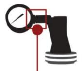
提示:為確保壓力錶的使用 安全及準確性,請將螺絲拴 緊,最多看到一圈螺紋。
