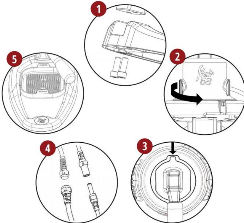
1. 將基座及壓桿組立用螺絲鎖緊
