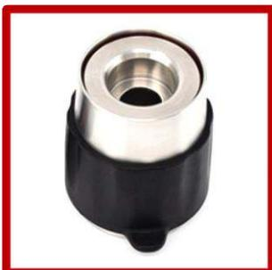
將不鏽鋼柱塞從頂端置入汽缸，柱塞上有較大直徑的一端向上，請確保置入汽缸的柱塞，其本身頂端位置是稍低於汽缸頂端上緣。
