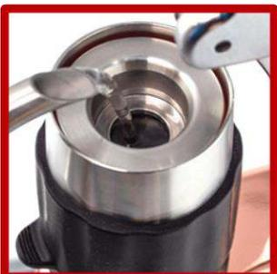
預熱完成後，請拿汽缸防燙矽膠部分，將汽缸反轉 180 度，然後壓入已放在濾杯座上的濾杯(同一般沒有使用壓力錶組的程序)，此時柱塞應該是在汽缸頂端，然後從柱塞孔中注入熱水。
