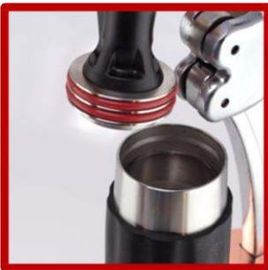
拿起已預熱的整個壓力錶組，將柱塞放入汽缸內，即可開始濾壓。
