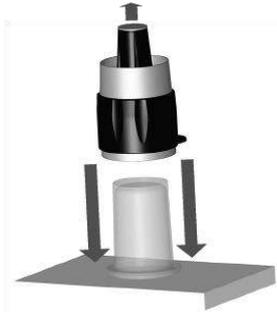
提示: 濾壓完成一杯 espresso 後, 可以使用量杯將活塞推出, 作法是將量杯放在一個硬的平面上, 然後將活塞推出。
